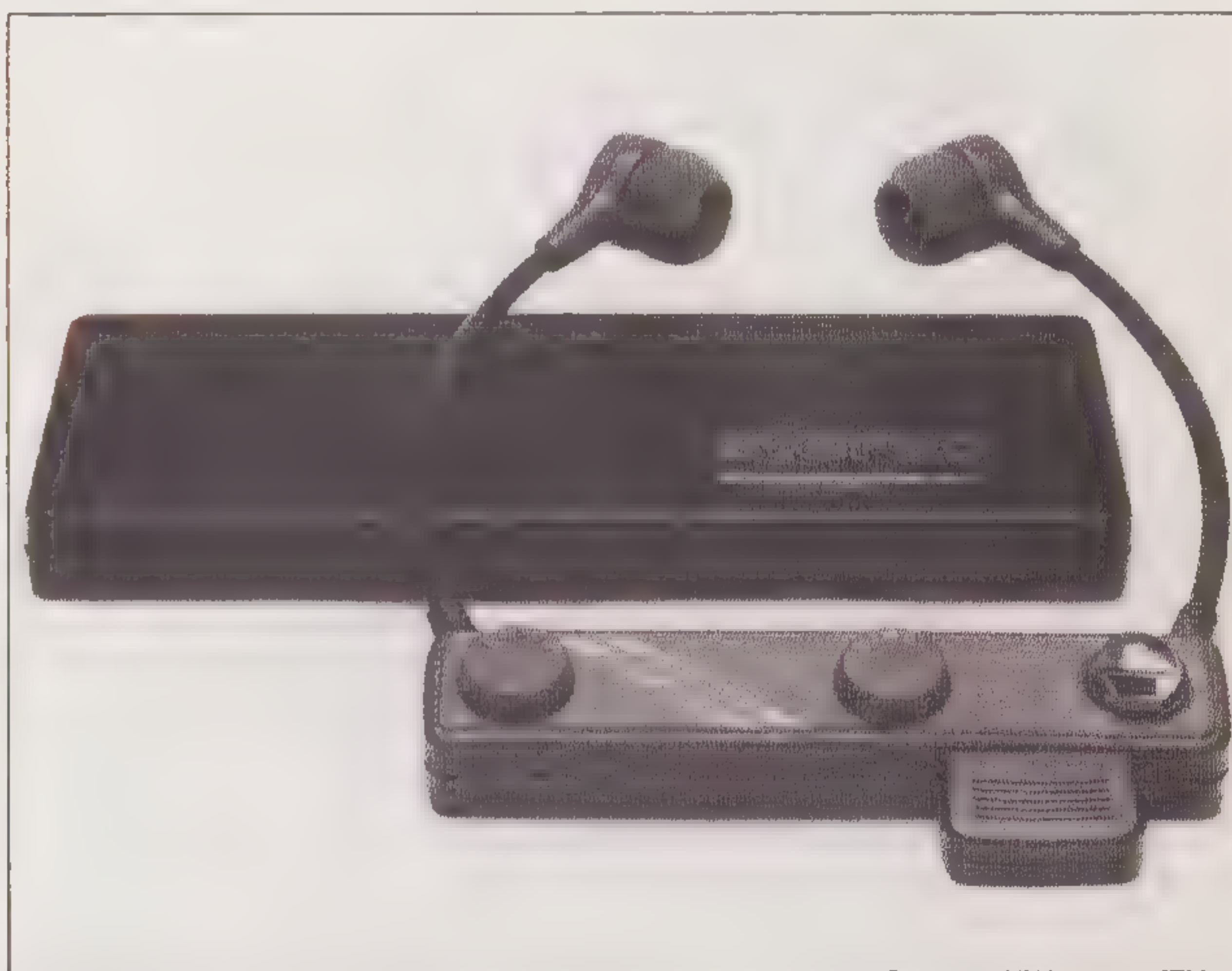
De zender SI 2 en op de voorgrond de ontvanger HDI 2. In de laatste is de oplaadbare accu/netstekker gestoken. De volumeregelaar en de keuzeschakelaar zijn heel praktisch op het front aangebracht.
